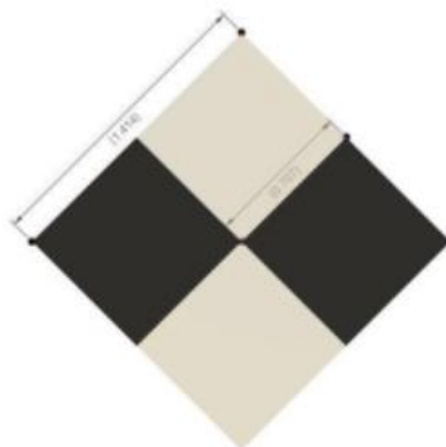
شکل ۳: تارگت مصنوعی طراحی شده برای نقاط کنترل زمینی
